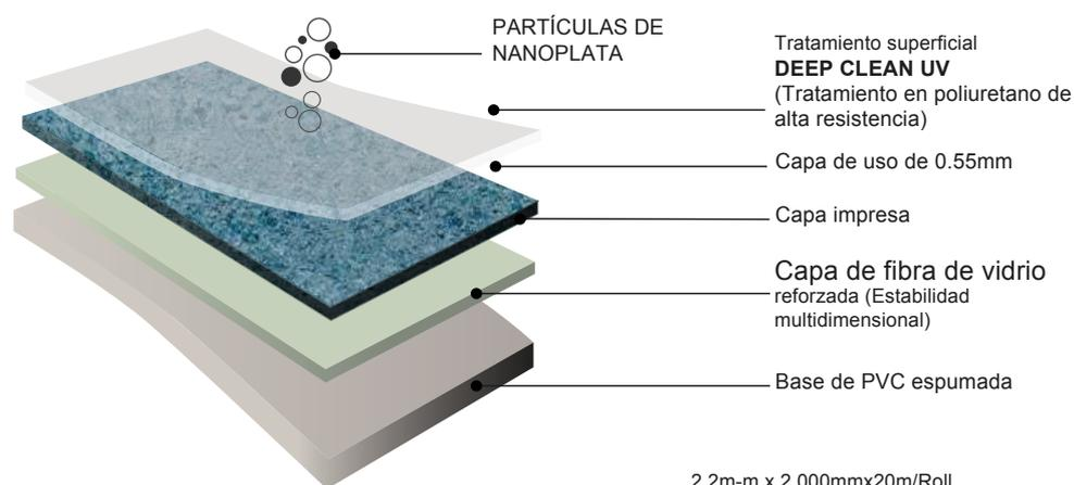
El piso en rollo vinilo heterogéneo es aquel que lleva varias capas en su fabricación: una capa base protectora con poliuretano reforzado (PUR), una central con revestimiento y una superior con desgaste, cada capa tiene una funcionalidad que otorga una propiedad determinada a los pisos en rollo
