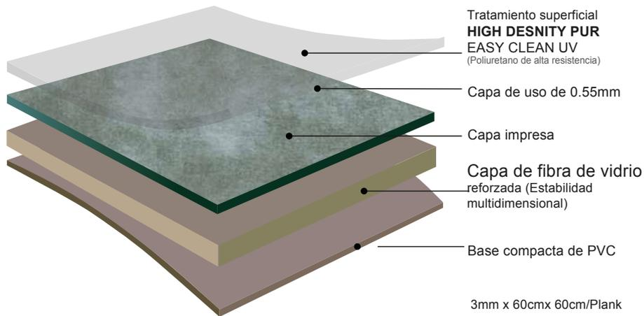
El piso en rollo vinilo heterogéneo es aquel que lleva varias capas en su fabricación: una capa base protectora con poliuretano reforzado (PUR), una central con revestimiento y una superior con desgaste, cada capa tiene una funcionalidad que otorga una propiedad determinada a los pisos en rollo
